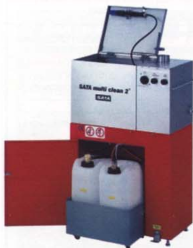
С помощью закрытых установок для чистки краскопульты заметно экономится время и растворитель
