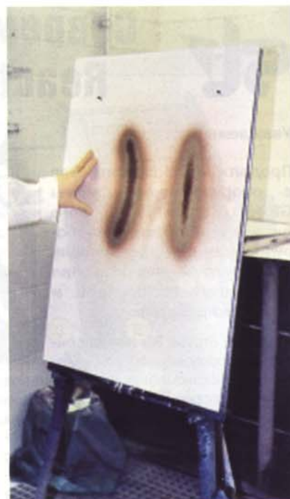
Одни "бананы"?! Если факел имеют такую форму, краскопульт требует ремонта. Если "банан" выклеван в левую сторону, загрязнено одно из отверстий на «рогах» воздушной головки. Если же в правую сторону, виноват маляр: установлено неправильное распылительное сопло, высокая вязкость краски или низкое давление воздуха
