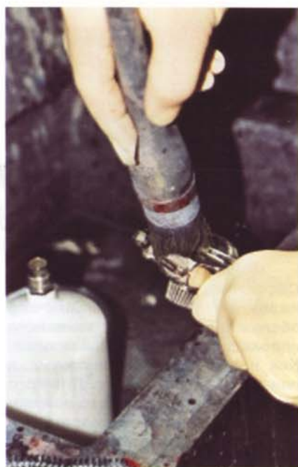
Перед разборкой пистолета проводится внешняя чистка. Через внутренний канал краскопульта прокачивается (чистый!) растворитель пока он не станет таким же на выходе
