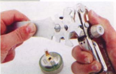
Для генерального ремонта краскопульт необходимо полностью разобрать. При разборке пользуйтесь только специальным инструментом. В комплект поставки новых краскопультов SATA входит все необходимое
