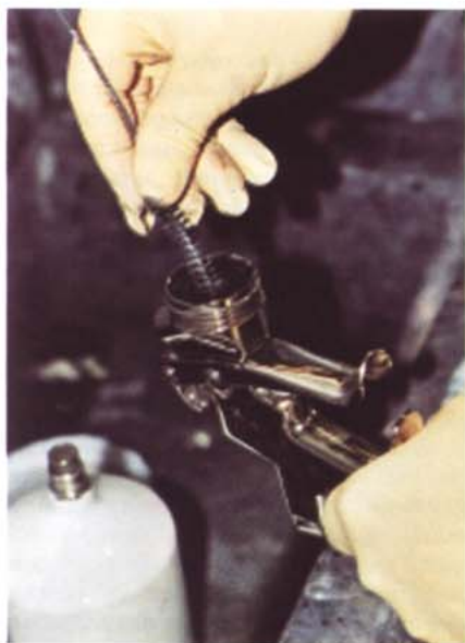
С помощью ершика очищаются отверстия пульверизатора от остатков краски. Для чистки маленьких отверстий используются специальные иглы. Не заталкивайте остатки краски внутрь пистолета!
