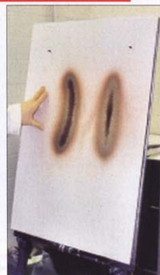
Фото 3. Одни бананы? Если факел имеет такую форму, краскопульт нуждается в ремонте. Если «банан» выклевлен в левую сторону, загрязнено одно из отверстий на «рогах» воздушной головки. Если же в правую сторону – виноват маляр: установлено неправильное распылительное сопло, высокая вязкость краски или низкое давление воздуха
