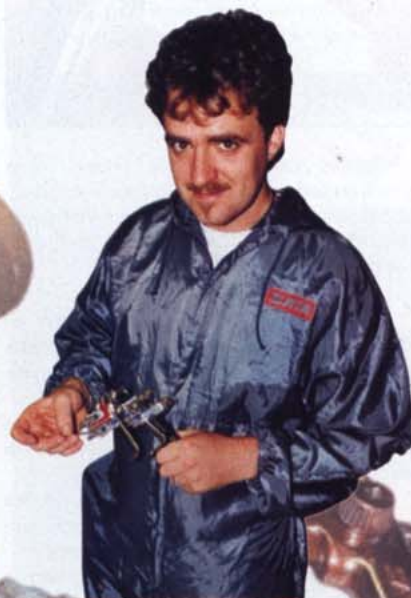
5 – На макете краскопульты SATAjet, разрезанного вдоль. Ральф Зайтер показывает, как нужно чистить сопло пистолета. Скрепки, насадки, проволока или сверла могут повредить краскопульт, что приведет к его неправильной работе
