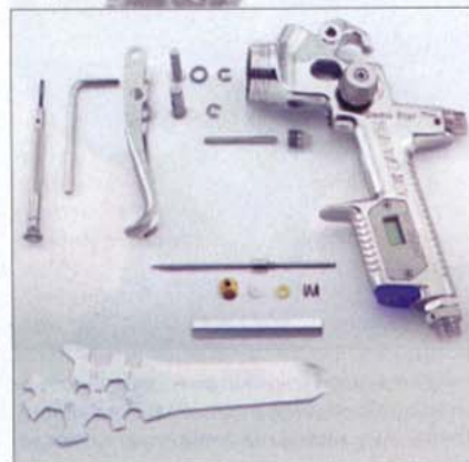
6 – Для генерального ремонта краскопульт необходимо полностью разобрать. При разборке нужно пользоваться только специальным инструментом. В комплект поставки новых краскопультов SATA входит все необходимое
